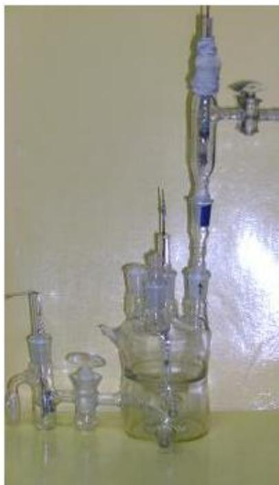
Рис. 3. Стекло́нная электрохимическая ячейка.
